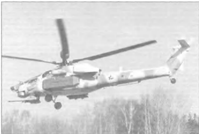
Ми-28Н. Радар, на воздухозаборнике двигателя — пелазитное устройство.
